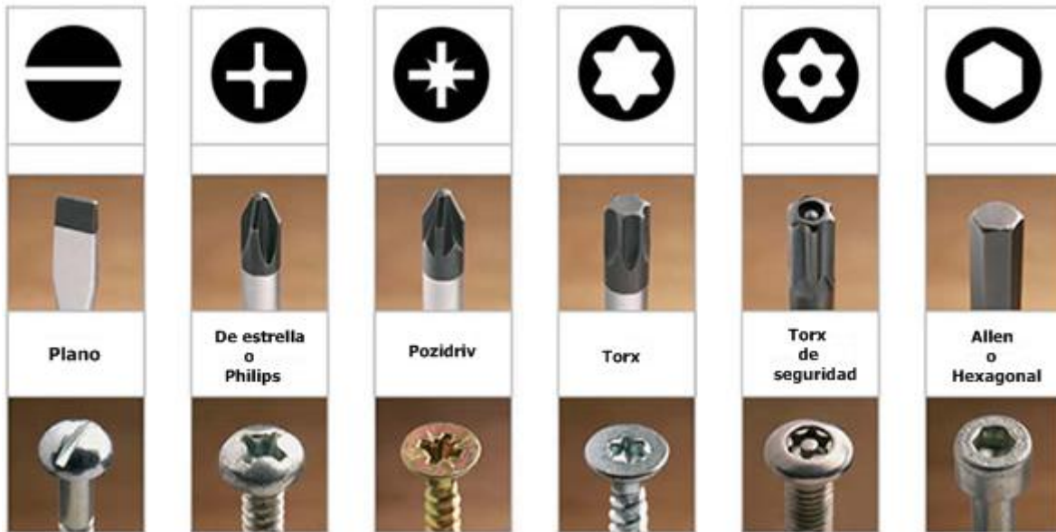
Distintos tipos de llaves según el tipo de cabeza de tornillo
