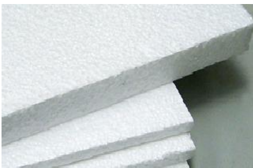
POREXPAN (mal conductor térmico, buen aislante térmico)
