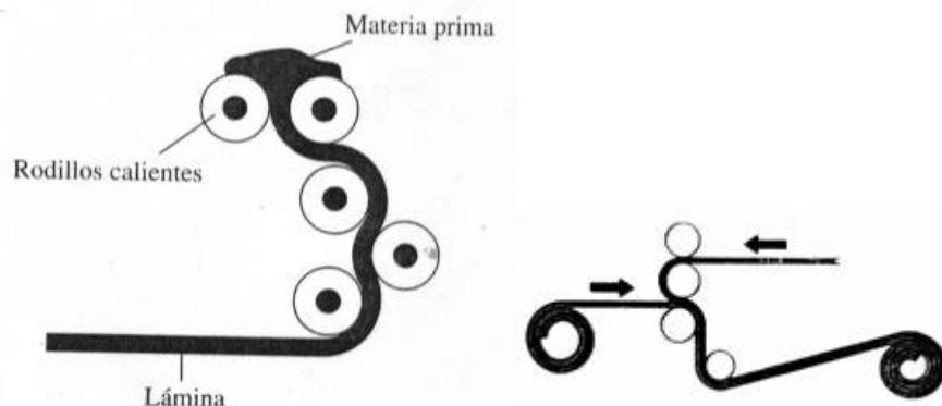
Este proceso permite fabricar planchas de PVC, carpetas, toldos, láminas para la agricultura, revestimientos de suelos, plásticos impermeables, etc. a partir de plásticos termoplásticos generalmente.
