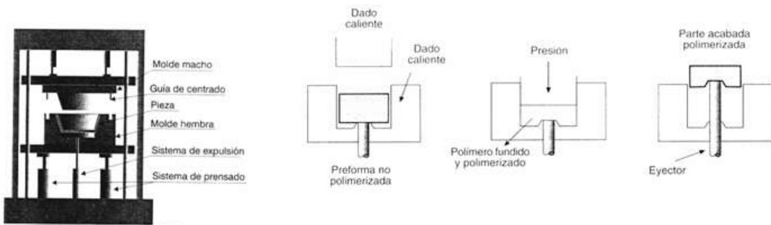
El moldeo por compresión se aplica para obtener accesorios eléctricos (interruptores, enchufes, etc.), mangos de cazos y de cubiertos, tapones de botellas, pomos de puertas, recipientes para alimentos y en sanitarios y fregaderos.
