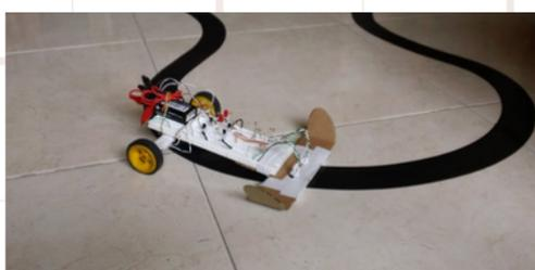
ROBOT SEGUIDOR DE LÍNEA
