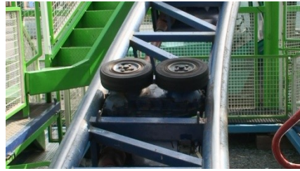
Transmissió de moviment mitjançant rodes de fricció (atracció de fira)
