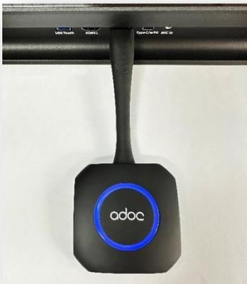
Otra opción para compartir pantalla desde un PC es utilizar el *Dongle*. Este dispositivo se conecta a un puerto USB de un ordenador con sistema operativo Windows para compartir su pantalla.
