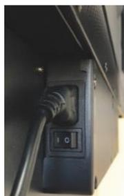
En la parte posterior tenemos la conexión de alimentación 220AC y un interruptor. También un enchufe de salida para alimentar un equipo desde el panel.
