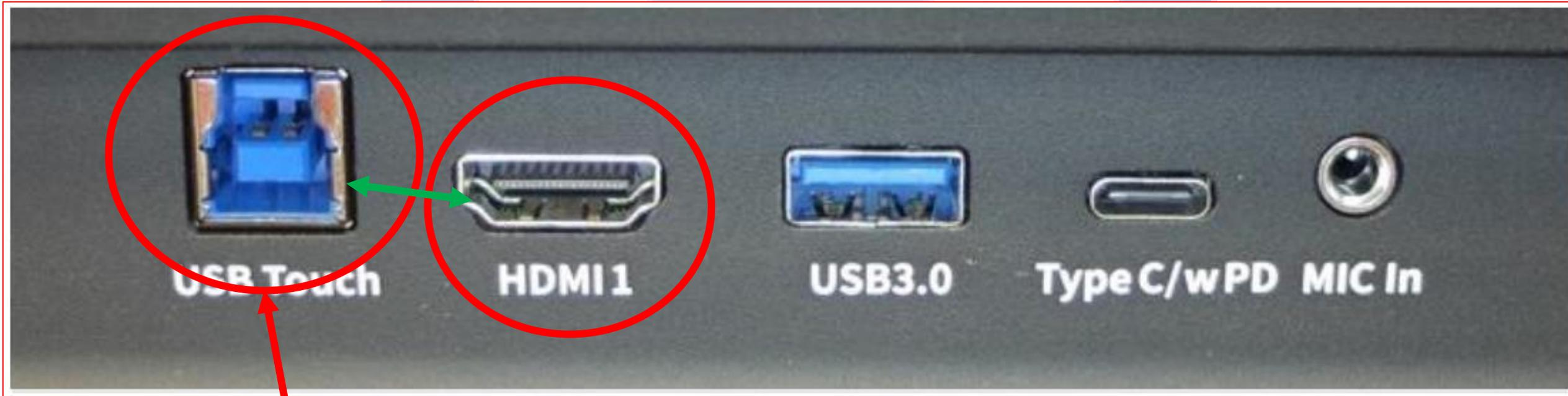
Este puerto USB debemos conectarlo al portátil si usamos la entrada HDMI 1 del panel frontal obligatoriamente, ya que funcionan emparejados. Sirve para poder manejar el PC dando toques a la pizarra, si no lo conectamos, necesariamente debemos actuar sobre el ordenador.
