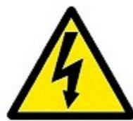
Descarga eléctrica (Precaución)
