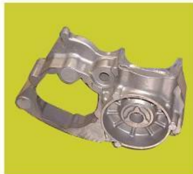
Fotos de productes elaborats per injecció de metall: un radiador, la carcassa d'un motor i una llanta.
