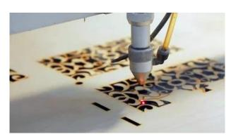
móviles, y parcialmente fijos, a través de los cuales se envía un rayo láser generado en un tubo láser. Con la ayuda de estos espejos y lentes, el láser se redirige y se trata para que pueda dirigirse a la interfaz deseada con poca pérdida y alta precisión.
