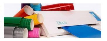
vectoriales en diferentes materiales. Por lo tanto, es uno de los pocos dispositivos que puede reproducir un gráfico vectorial inmediatamente sin tener que convertirlo antes en un gráfico ráster. El *cutter* (cortador) es un trazador, pero que utiliza una cuchilla en lugar de un bolígrafo. La cuchilla se puede usar para cortar contornos de un gráfico vectorial en materiales delgados como láminas autoadhesivas, cartón, papel, cuero, fieltro, y mucho otros materiales.
