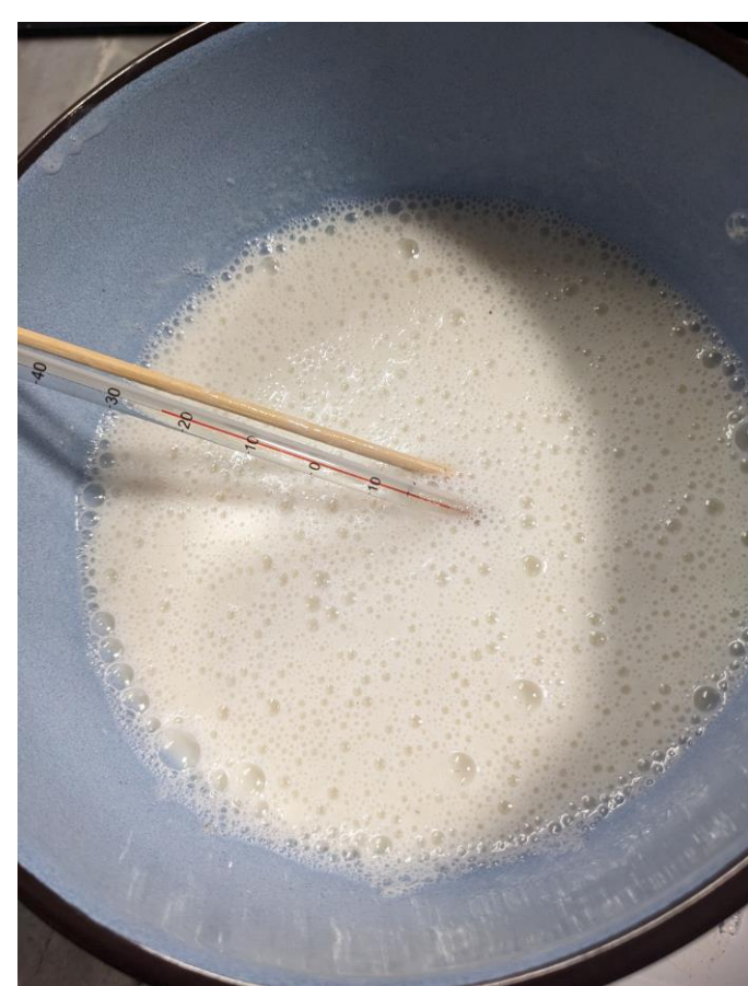
P7. Preparació de dissolució amb llet. La llet es talla pel pH de l'ADP.
