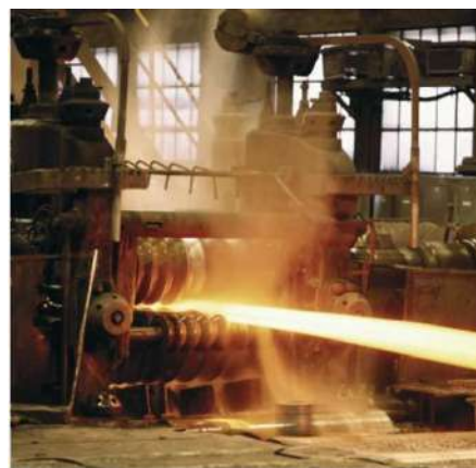
Acer amb la forma comercial «llanta» sortint de la laminadora en calent.
