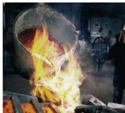
L'operació d'abocar dins un motlle un metall fos s'anomena colada .
