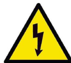
Senyal de risc elèctric.
