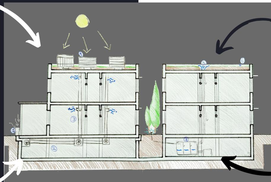
El agua que se ha recogido en la cubierta por las lluvias (5), o desde los lavabos, bajaría por tuberías hacia la depuradora y depósitos (7) y, por medio de bombas, se reutilizaría para riego o cisternas de WC.
