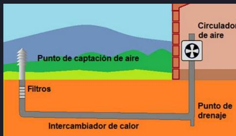
Se basa en tres partes: el punto de captación de aire y filtro (1); el intercambiador de calor (2); este sistema se integraría en las aulas mediante conductos de ventilación (3).
