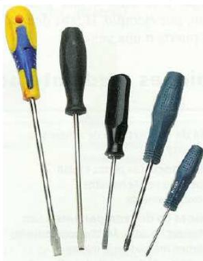
Está compuesto por una pieza metálica acabada en punta, plana o con forma de estrella, según el tornillo al que esté destinado, y un mango de material aislante de la corriente eléctrica (plástico o madera).
