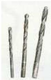
Son unas barras cilíndricas de acero con ranuras. Se incorporan a las taladradoras en su extremo y son las que realizan los agujeros. Según su uso, las brocas pueden ser de diferentes materiales, longitudes y diámetros.
