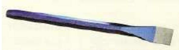
Son herramientas formadas por una punta de doble bisel. Se utilizan para tallar el material golpeando con un martillo sobre el mango con un ángulo de incidencia sobre el material de unos 5°.
