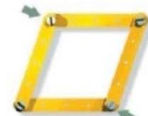
Para evitar que las estructuras se deformen, en su armazón se incorporan elementos que forman triángulos.
