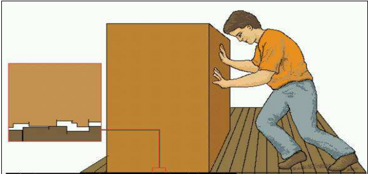
Figura 16. Al intentar deslizar un objeto sobre una superficie se manifiesta la fuerza de rozamiento en sentido opuesto al sentido del movimiento. Según el grado de rugosidad de las superficies en contacto la fuerza de rozamiento será mayor o menor. La persona debe conseguir vencer la fuerza de rozamiento para lograr que el armario se desplace.
