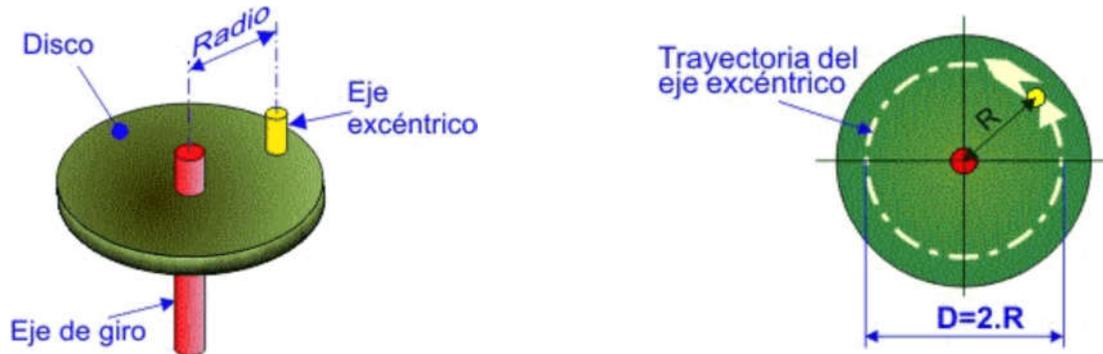
La carrera en una rueda excéntrica es la distancia entre el punto máximo que alcanza un vástago unido al eje excéntrico y su punto mínimo, que equivale a 2 veces el radio de la manivela.
