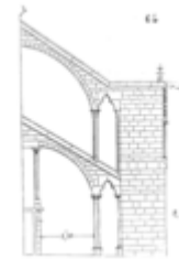
Arbotantes o arcos exteriores que separaban los contrafuertes del muro y lo aligeraban..
