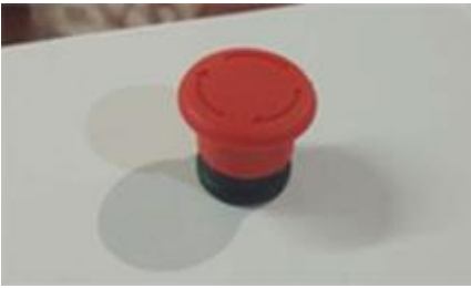
Figura 3-9 Pulsador de emergencia
