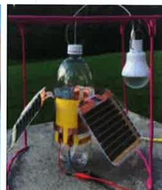
El dispositivo captura energía que está constantemente disponible en nuestro entorno - como energía vibratoria generada por el viento- para generar energía limpia"
