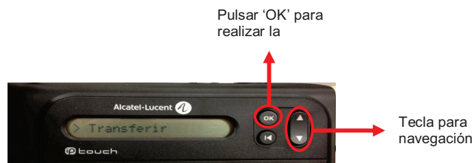
Fig. 12: Transferencia desde terminal IP
