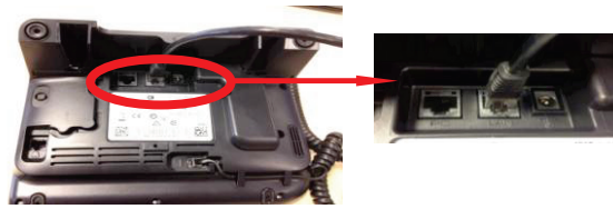
Fig. 2: Conexión del teléfono IP a la roseta. El cable debe estar conectado en el puerto etiquetado como 'LAN' del teléfono. El otro extremo del cable podrá estar conectado a una roseta del edificio o directamente en el router de Secretaría.
