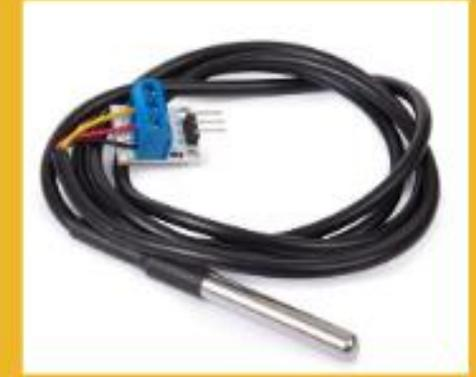
Sensor pH 4502C y sensor temperatura DS18B20
