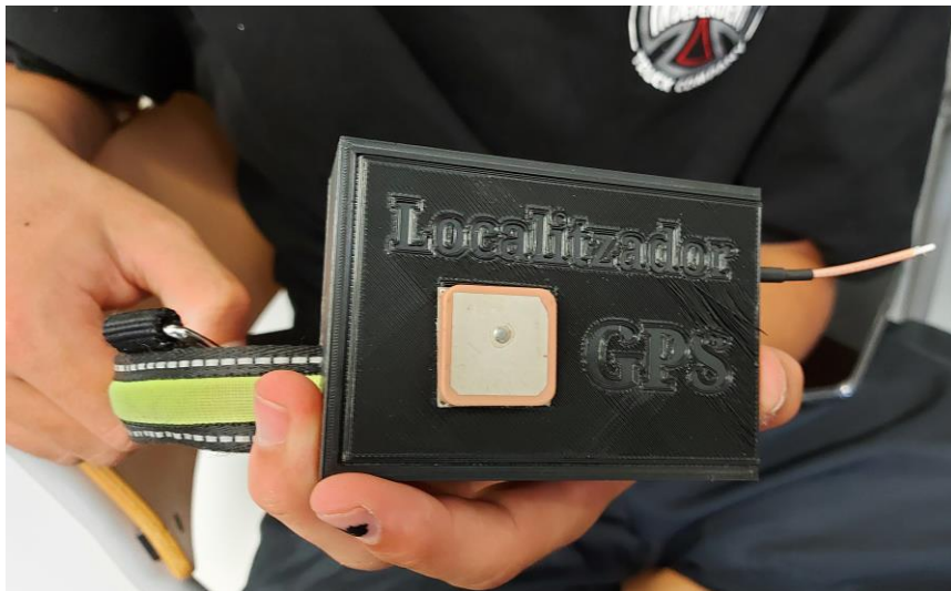
Localitzador GPS per a gossos (Arduino)
