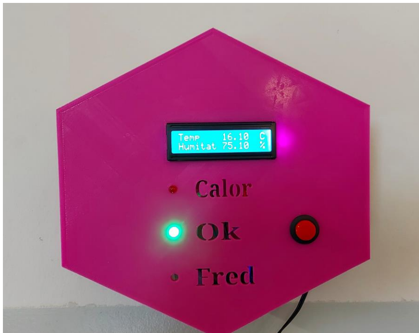
Estació meteorològica amb Arduino – 3r ESO
