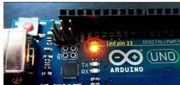
*LED encendido en la placa Arduino Uno*
