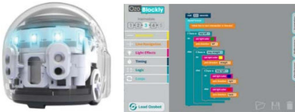
En cuanto a los sensores y actuadores del robot, consta de un sensor de proximidad para detectar obstáculos, un sensor óptico (sensor de luz/color) para detectar líneas y códigos de colores, LED de colores y un altavoz.
