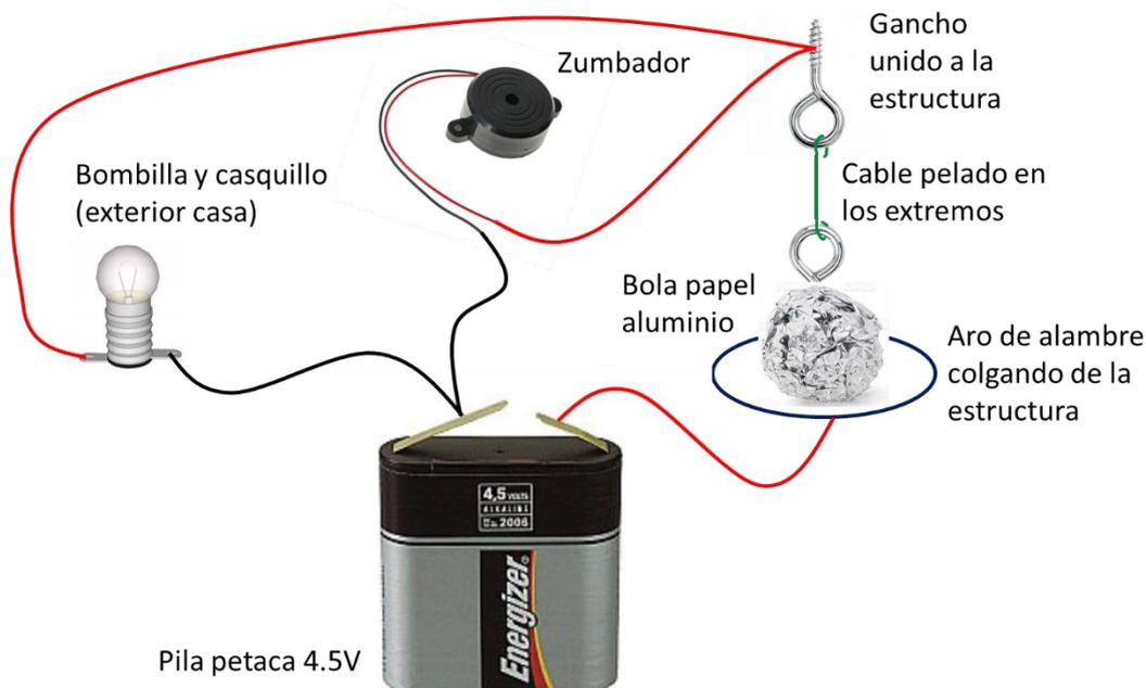
Como podéis ver, colocaremos un cáncamo en algún punto de la viga de cumbrera. A este cáncamo tendremos que conectar eléctricamente la bombilla y el polo positivo del zumbador, que es el cable rojo (*¡ojo, porque es importante que sea el positivo!*).
