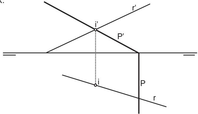
Hallar el punto de intersección i-i' del plano P con la recta de perfil R determinada por sus trazas V y H.
