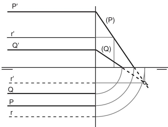
Determinar la recta R de intersección del plano P con el plano Q.
