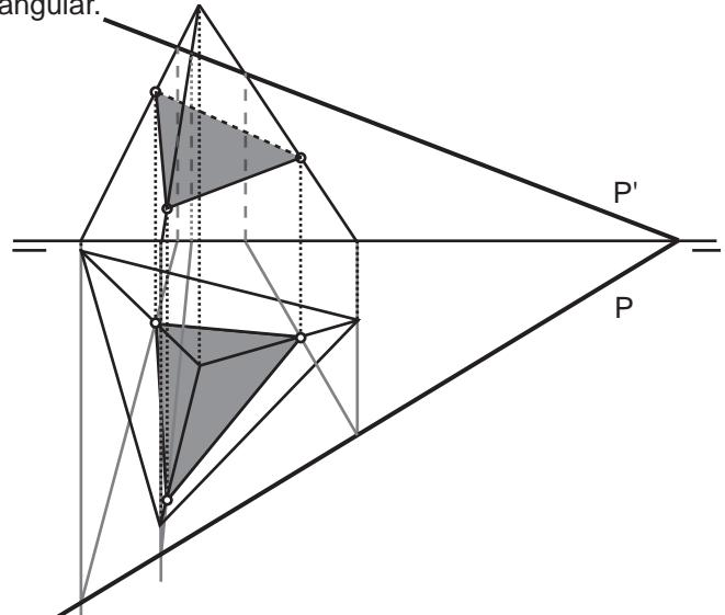
Determinar la sección que produce el plano P en el cubo.
