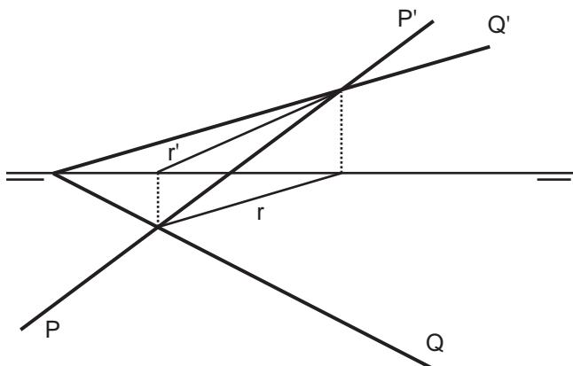
Determinar la recta R de intersección del plano P con el plano Q.
