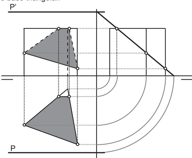
Trazar la sección producida por P, paralelo a LT en el prisma oblicuo de base triangular.
