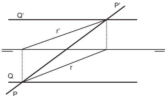
Determinar la recta R de intersección del plano P con el plano Q.
