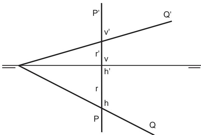
Determinar la recta R de intersección del plano P con el plano Q.
