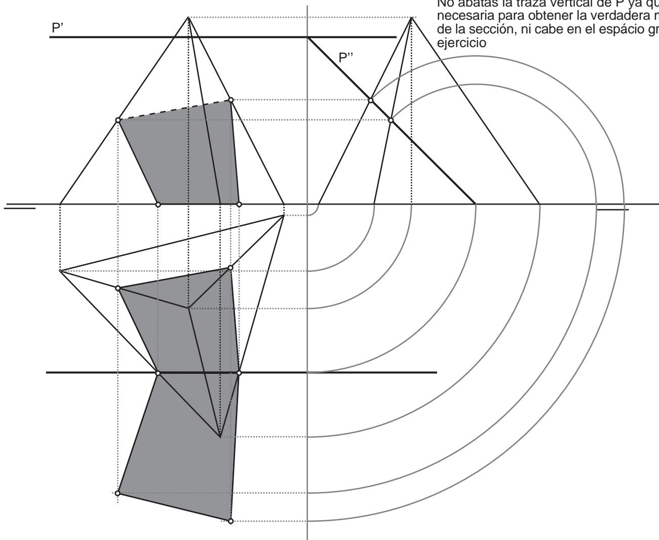
Dadas las proyecciones vertical y horizontal del cubo apoyado en un vértice sobre PH, determinar la 3<sup>a</sup> proyección del cubo y la sección que produce sobre el el plano de perfil dado
