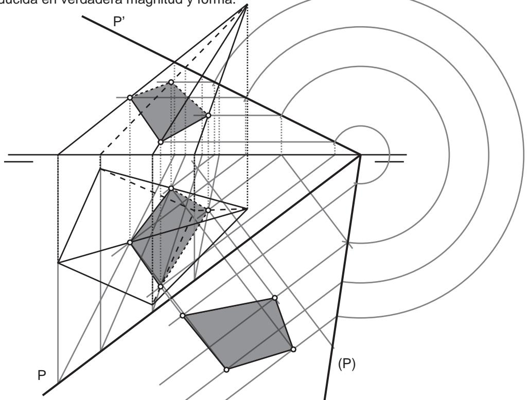
Dadas las proyecciones del prisma recto de base pentagonal y el plano P, determina las proyecciones de la sección producida y abátela sobre el PV de proyección.
