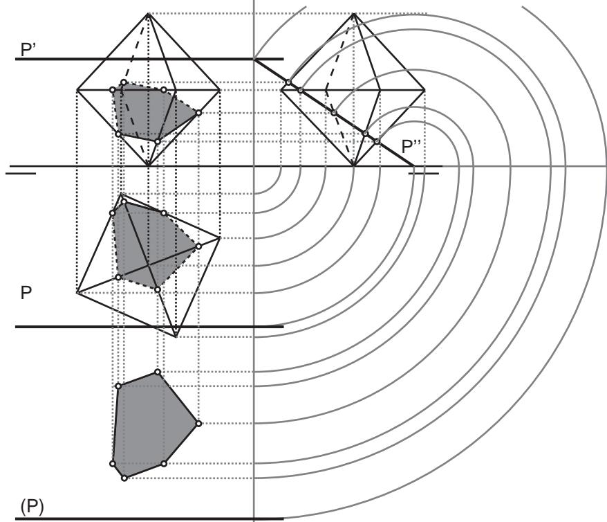
Dadas las proyecciones del prisma oblicuo de base cuadrada y el plano P paralelo a la linea de tierra determinar la sección plana en verdadera magnitud y forma que el plano produce con el prisma.
