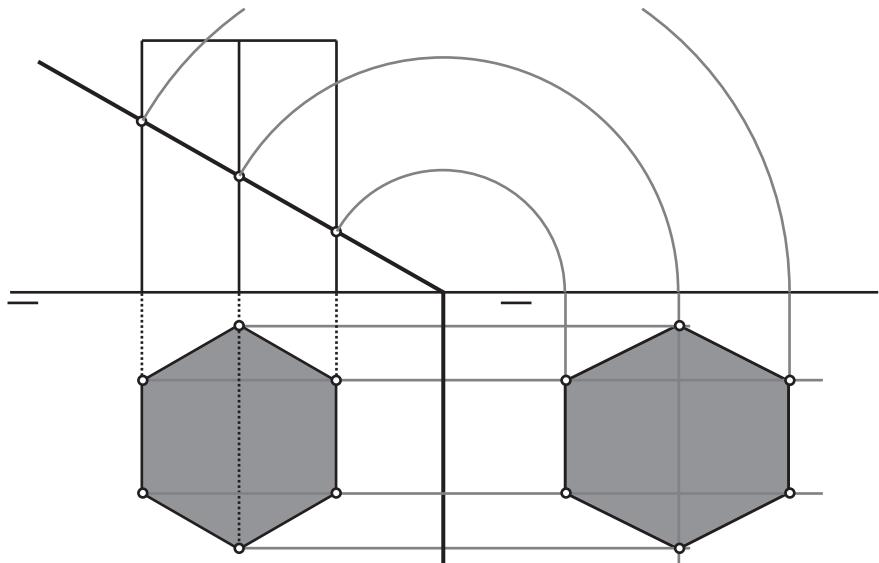
Dada la pirámide recta de base hexagonal y el plano P determina las proyecciones de la sección y su verdadera magnitud y forma.
