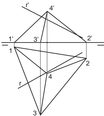
Para resolver este problema contendremos la recta que produce la intersección en un plano proyectante (horizontal o vertical a conveniencia). Una vez contenida la recta en el plano hallaremos la sección plana que este produce en el poliedro para poder observar las intersecciones que la recta dada produce sobre los segmentos del contorno de la sección plana.
