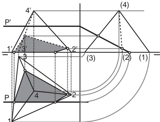
En esta ocasión para devolver los puntos hallados en tercera proyección a proyección horizontal y vertical hemos llevado las cotas de los puntos de intersección a las proyecciones verticales de las rectas y luego hemos bajado estas a sus proyecciones horizontales.
