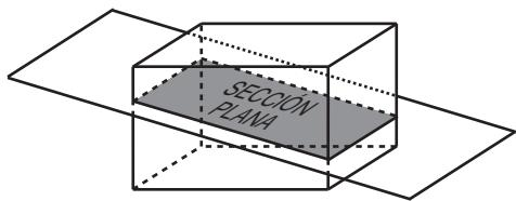
**Sección Recta:** Es la sección plana de un cuerpo cuando es cortado por un plano perpendicular al eje de este.
