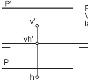
Para resolver este problema necesitaremos pasar a tercera proyección la recta y el plano. Vistos de perfil la intersección es obvia. Una vez determinada debemos llevar la solución sobre la recta a las proyecciones horizontal y vertical.
