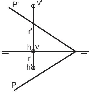
Para este caso debemos contener en el plano una recta de perfil con la misma lateralidad que la recta dada. Padadas ambas rectas a una tercera vista de perfil localizamos el punto de intersección que podemos devolver a las vistas horizontal y vertical.
