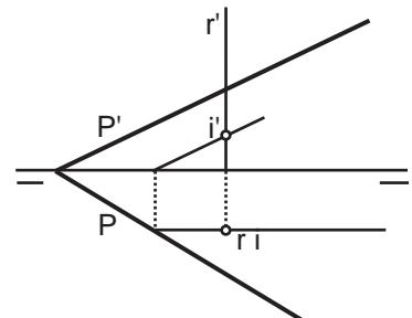
Hemos explicado e ilustrado dos métodos para la intersección de planos oblicuos con rectas verticales. El sistema sería igual para rectas de punta (o perpendiculares al PH), para resolver el problema con estos tipos de recta deberíamos usar bien un plano proyectante vertical o una recta horizontal.
