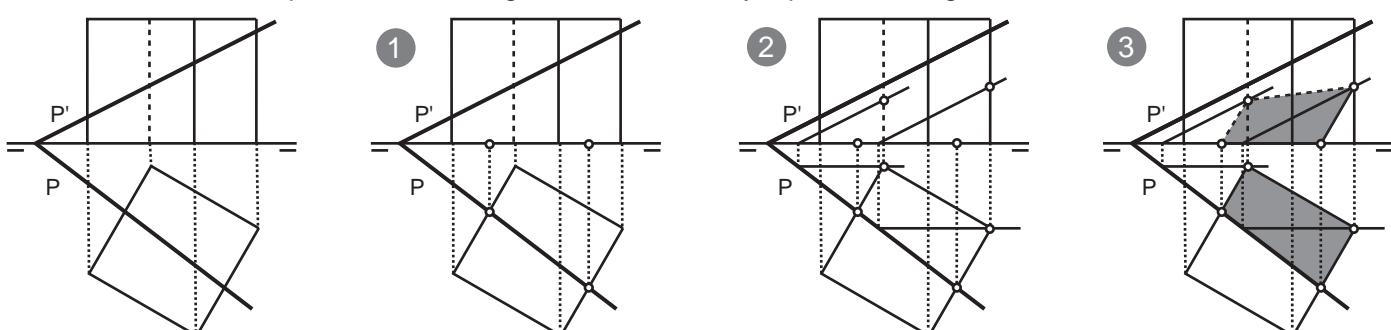
1º- Encontramos los puntos de intersección de P con la base. 2º- Trazamos rectas frontales contenidas en P con el mismo alejamiento que las dos aristas susceptibles de ser cortadas por P, encontramos los puntos de intersección.
