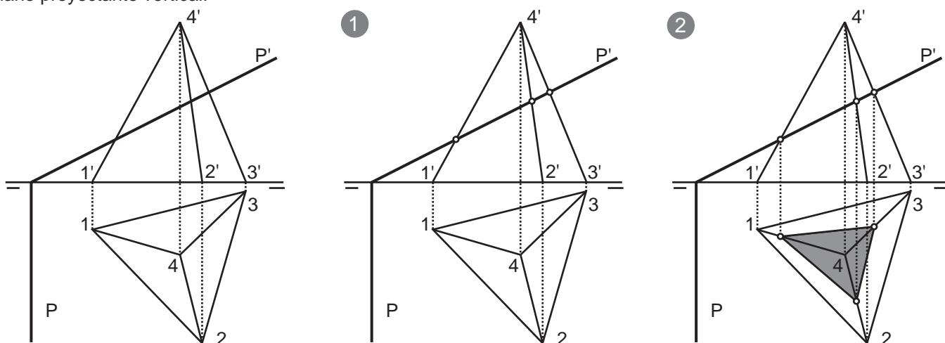
En estos casos de secciones producidas por planos proyectantes una de las proyecciones de la sección queda siempre contenida en su totalidad en la traza del plano oblicuo a LT.
