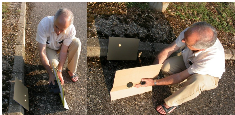
Figura 3: Observación segura del Sol mediante la proyección de su imagen con unos prismáticos convenientemente enfocados a la pantalla. El enfoque fino se consigue ajustando la corrección dióptrica del ocular.
