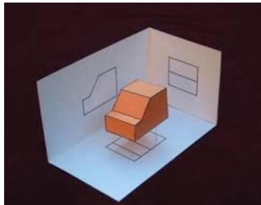
En el següent exemple, al desplegar els tres plànols obtenim [les vistes](#) de la peça amb correspondència de mesures:
