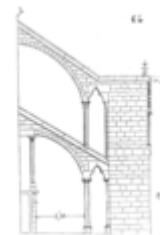
Arbotantes o arcos exteriores que separaban los contrafuertes del muro y lo aligeraban..
