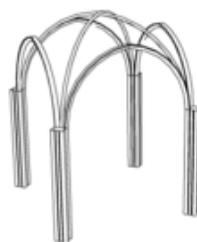
Bóveda de crucería , surgida al cruzarse dos arcos apuntados. El peso se concentraba en las columnas y liberaba los muros.
