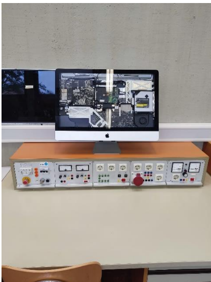
Banco de trabajo con conexionado y medidores junto con a equipo informático para aprender componentes y desmontaje.
